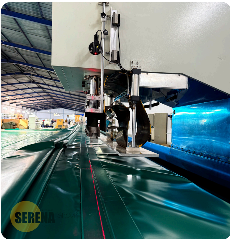
Máquina de soldadura de alta frequência em mesa de 30 metros de comprimento
